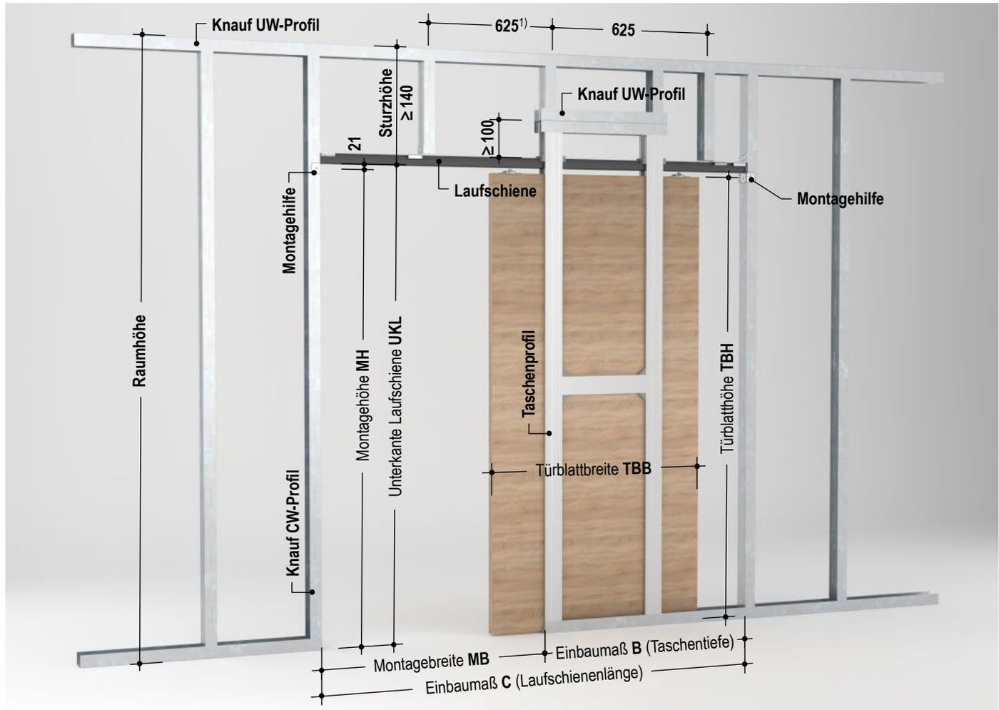
1) Bei Türblattbreite > 985 mm Achsabstand auf 312,5 mm reduzieren
