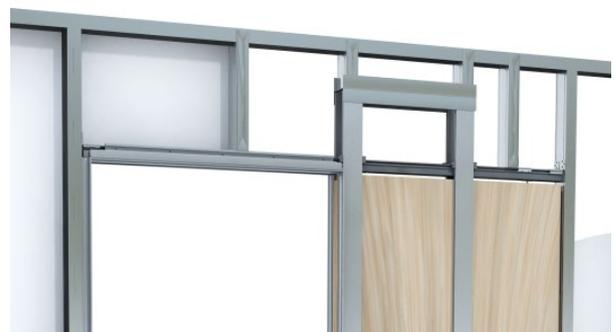
Bei Befestigung des Holztürblatts mit der verdeckten Türblattaufnahme muss die verdeckte Türblattaufnahme als gesonderter Artikel bestellt werden. Für den Einsatz der verdeckten Türblattaufnahme in das Holztürblatt bei einem Türblattgewicht  $> 80 \text{ kg} \leq 120 \text{ kg}$  ist ein Vollspantürblatt oder Türblatt mit  $\geq 70 \text{ mm}$  breitem Vollholz-Türblattrahmen zu verwenden.
