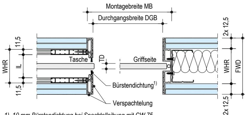
1) 10 mm Bürstendichtung bei Spachtellaibung mit CW 75
